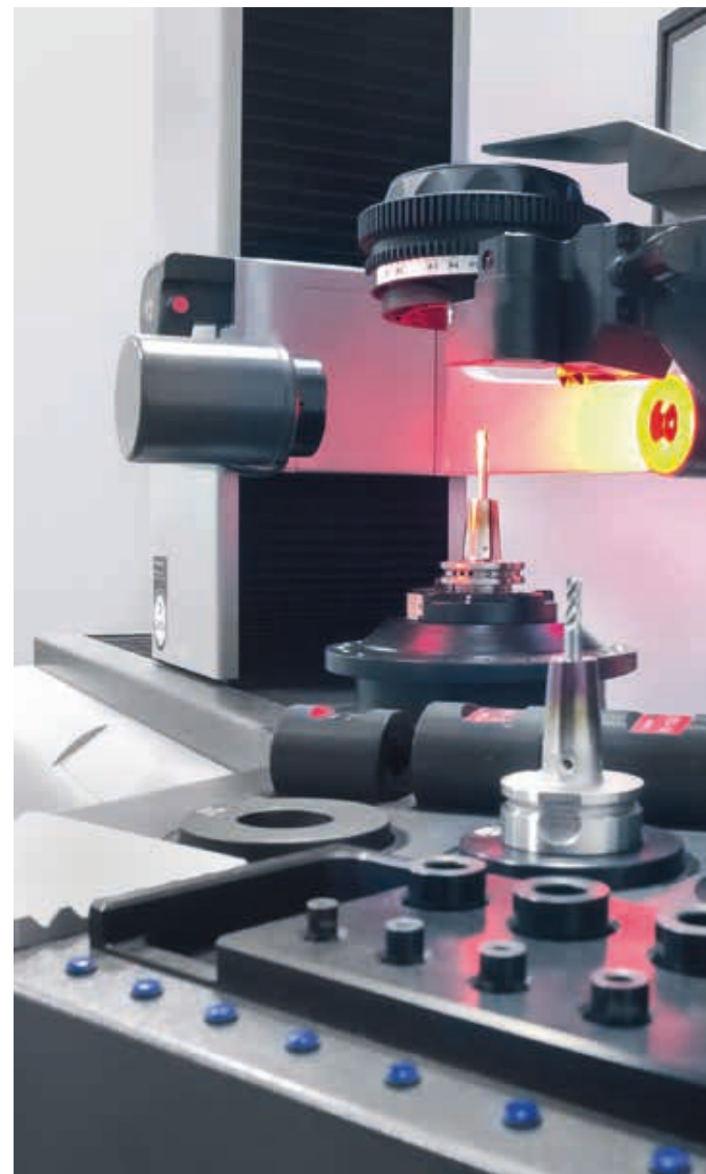
Oben: Das Einstell- und Messgerät »gemin« schafft 80 Schneiden in 120 Sekunden – wirtschaftlicher geht's nicht.
