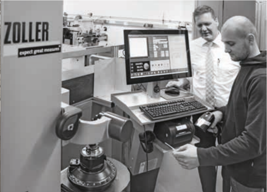
Einfache Werkzeugidentifizierung mittels QR-Code am Einstell- und Messgerät »venturion«.
