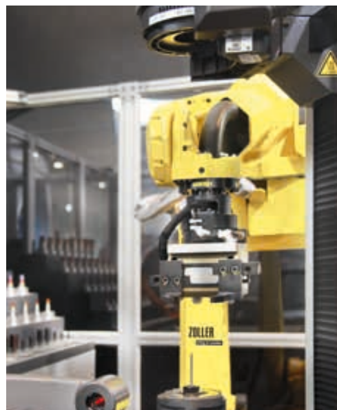
Oben: Das Einstell- und Messgerät »gemin« schafft 80 Schneiden in 120 Sekunden – wirtschaftlicher geht's nicht.
