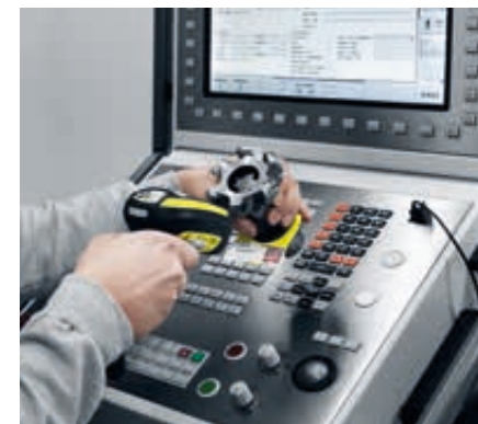
Einfache und schnelle Werkzeugidentifikation zur sicheren und automatischen Übertragung von Werkzeugdaten – »zidCode«.
