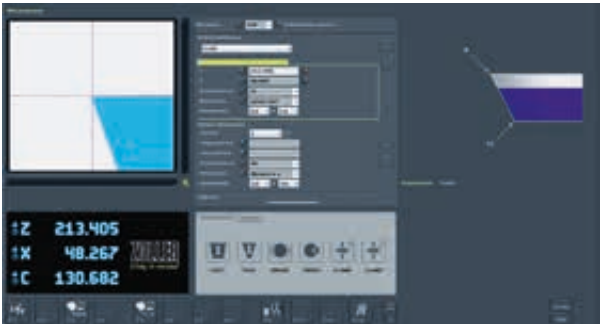
← ↑ Mit dem speziellen Programm von ZOLLER gelingt die Schleifscheibenmessung nach der FEPA Norm dank fotorealistischem Eingabedialog ganz einfach.
