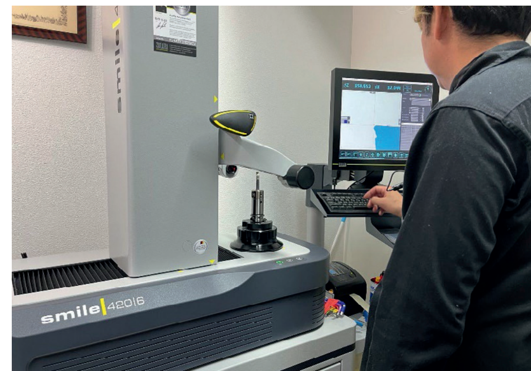
Die Bohrstange wird präzise und schnell eingestellt
