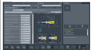
Automatisch zur 3D-Grafik: Für Monoblock- und Komplettwerkzeuge legt die Software TMS Tool Management Solutions 3D-Volumenmodelle zum Konstruieren und Simulieren mit aktueller CAD/CAM-Software an.
